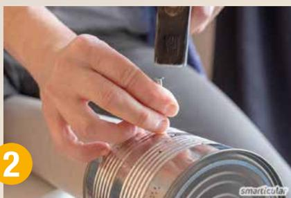
2 Die Dose am besten auf ein Papprohr oder einen dicken Holzstab stecken, der von innen Widerstand bietet. Den Stab so auf eine Tischkante legen, dass das Ende samt Dose über die Tischkante ragt und das andere Ende mit einem Arm auf dem Tisch festgehalten werden kann. Ist das Rohr lang genug, am besten draufsetzen.
