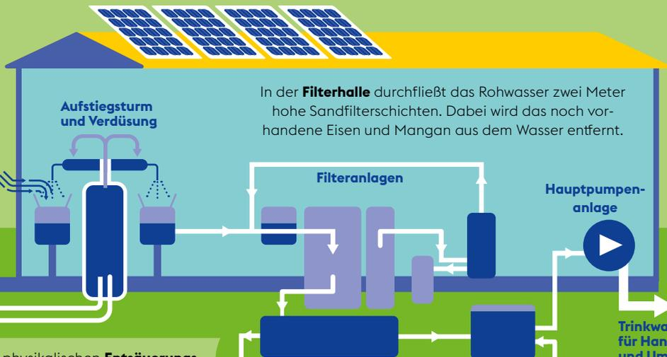
In der **Filterhalle** durchfließt das Rohwasser zwei Meter hohe Sandfilterschichten. Dabei wird das noch vorhandene Eisen und Mangan aus dem Wasser entfernt.
